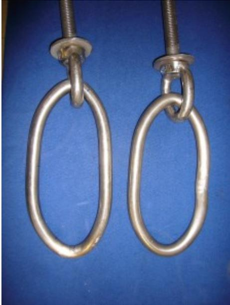
Il materiale per la realizzazione degli anelli è arrivato dalla Germania attraverso un grossista ed importatore toscano. L'anello modello è stato realizzato da un fabbro, che si è occupato della calandratura, cioè di piegare la barra dritta ad anello, e da una carpenteria inox, che si è occupata di completare la costruzione dell'anello, agganciandovi il perno avvitato, cioè la parte a vite che entra nel basamento.
