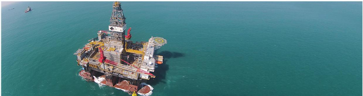
L'impianto di perforazione è quello di essere un nuovo design MOSS CS60E con un' alta specifica dell'unità di perforazione semisommersibile adatto per le operazioni in ambienti difficili, che è il primo MOSS CS60E ed il più grande impianto in tutto il mondo lo stato-of.
