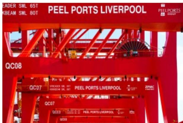
Le gru saranno in grado di eseguire una media di 20 carico/carichi per ora, con il controllo semi-automatico collegato al nuovo sistema operativo del terminale Navis N4 del porto. Hanno una capacità di 40 tonnellate sotto spreader-e un'altezza massima di sollevamento del contenitore sopra il livello banchina di 21m sotto spreader (6 + 1 container).
